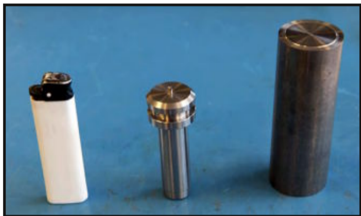
MAGI: Guttene måtte trylle frem en del som blant annet blir brukt som stempel i ulike sylindere. Arbeidet krever pugging av ulike programmeringskoder.
